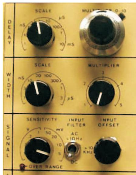
**Abbildung 7:** Schalter zum Einstellen des Gates
