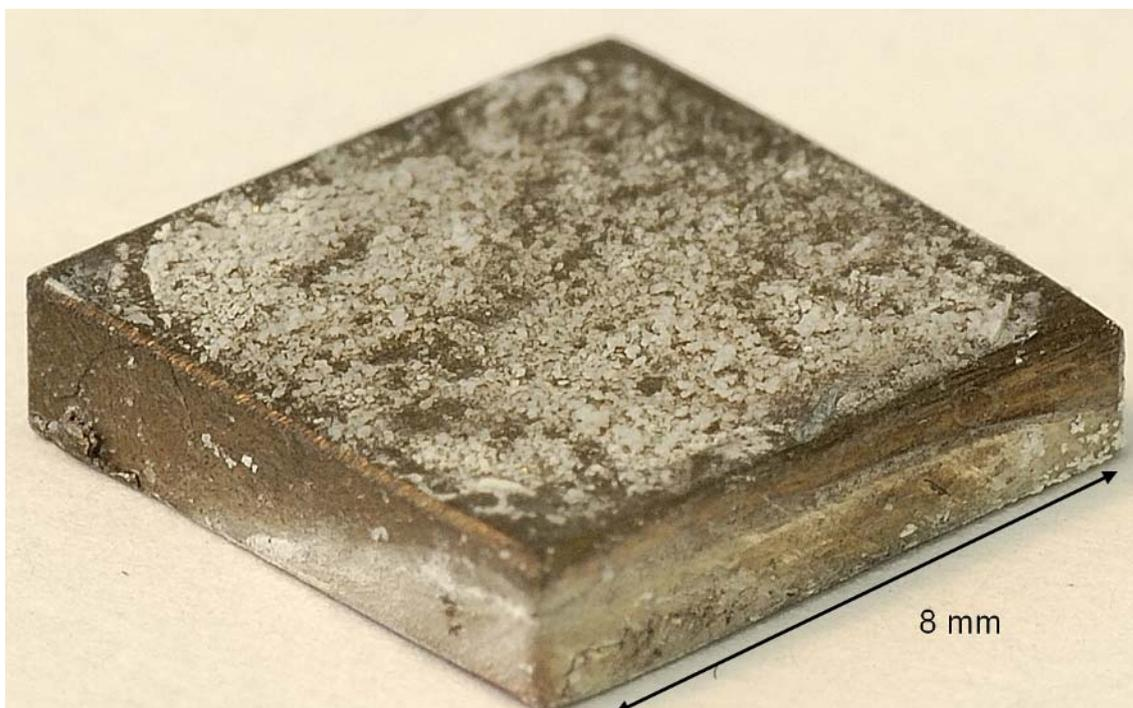
**Abb. 12.17:** Foto einer unbeschichteten Al7075 Probe nach einem 3-tägigem Bad in einer NaCl-Lösung (2,5% Lösung, hochreines Wasser, reines NaCl)
