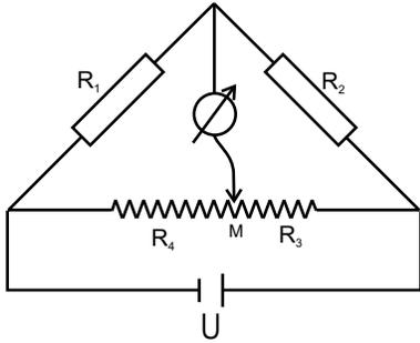
In der nebenstehenden Schaltung wird das Verhältnis der Widerstände von  $R_3$  und  $R_4$  mit Hilfe des Mittelabgriffs  $M$  so eingestellt, dass durch das Messgerät kein Strom mehr fließt.
