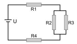
Für die Widerstände der gezeigten Schaltung gilt: R1 = 2  $\Omega$ , R2 = 1  $\Omega$ , R3= 3  $\Omega$  und R4= 1,25  $\Omega$ .
