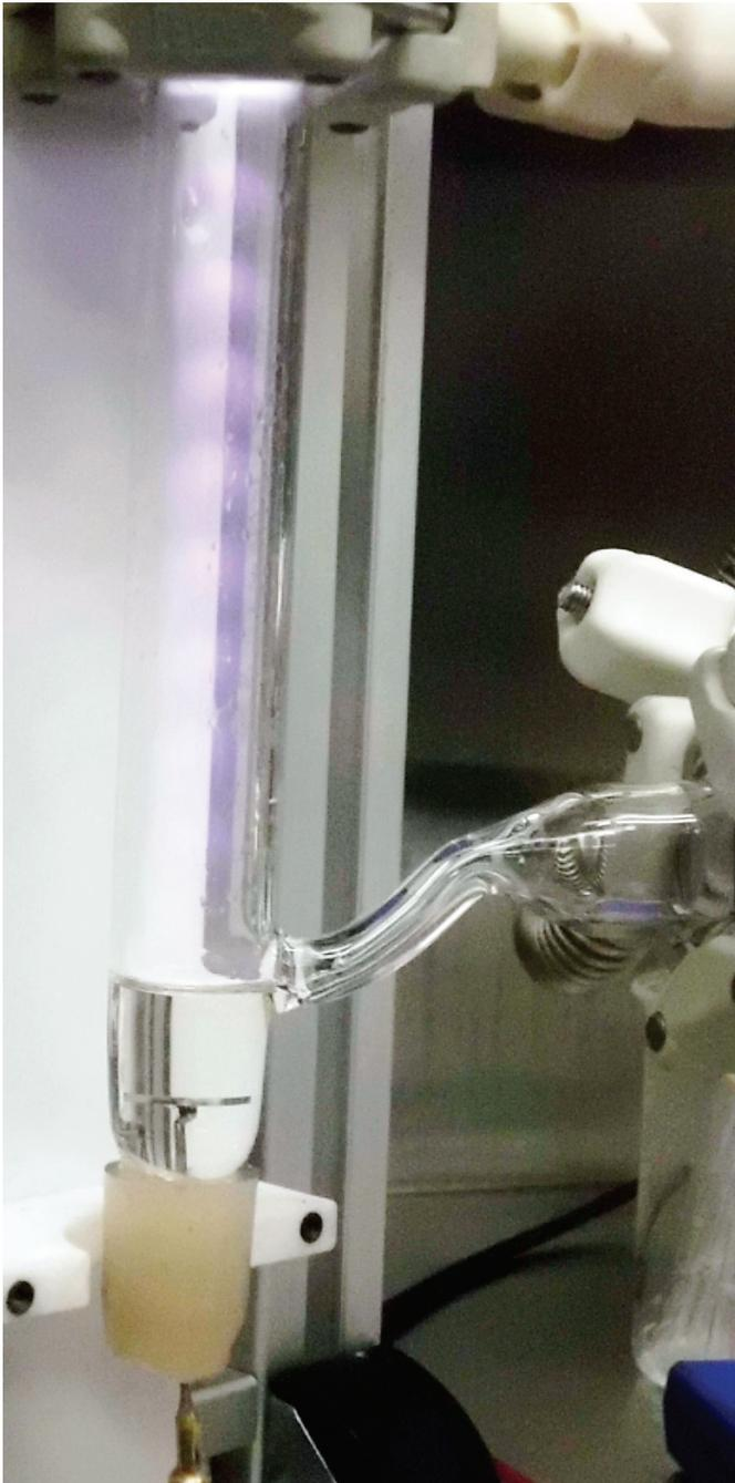
Abbildung 5: Modifizierte Plasmazelle für Experimente mit z.B.  $\text{SiCl}_4$
